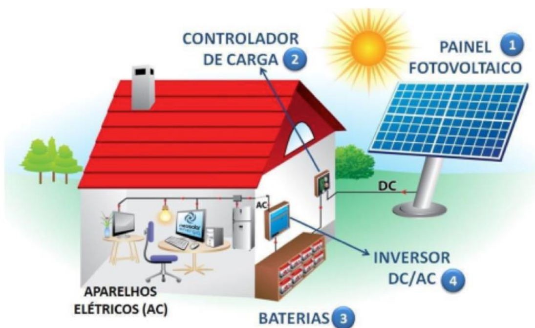
Figura 4: Sistema OffGrid. https://consultrevisolar.com.br/sistema-fotovoltaico-off-grid/
